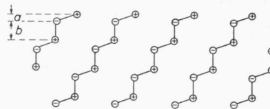
Abb. 2. Schnitt durch ein Zinkblendegitter senkrecht zu den 111-Flächen. Die Bildebene entspricht einer 110-Fläche.
